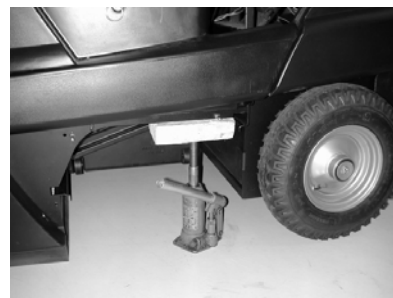
Точка установки домкрата (задние колеса)
